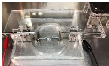
図 8 . 新たに開発した動的応力 - 電気刺激印加バイオリアクタ
