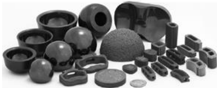
図1.窒化ケイ素製の整形外科用インプラント（文献1より引用）
