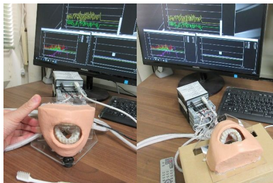
図 12 固定台を工夫して坐位及び仰臥位を想定した状況での口腔ケアが行えるシミュレータ。
