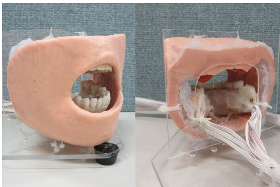
図 11 両側 14 本の歯にセンサを埋め込み、シリコンで作製した軟部組織モデル内に設置した口腔ケアシミュレータ。
