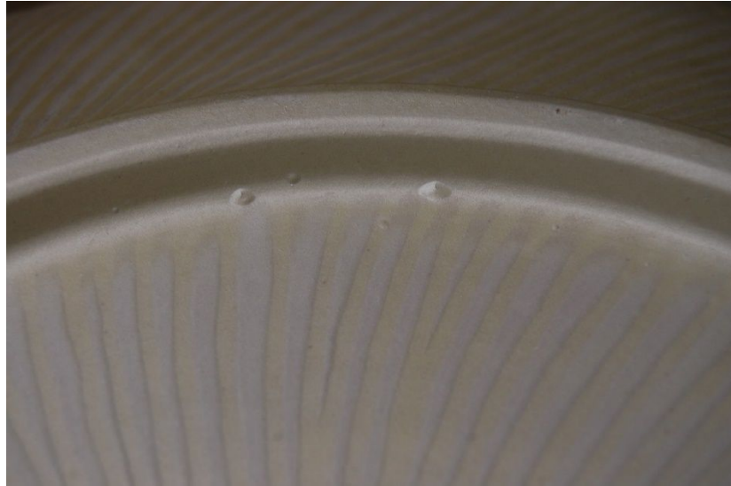
銀の剥離現象による銀被膜の気泡状の膨れ (図1)
