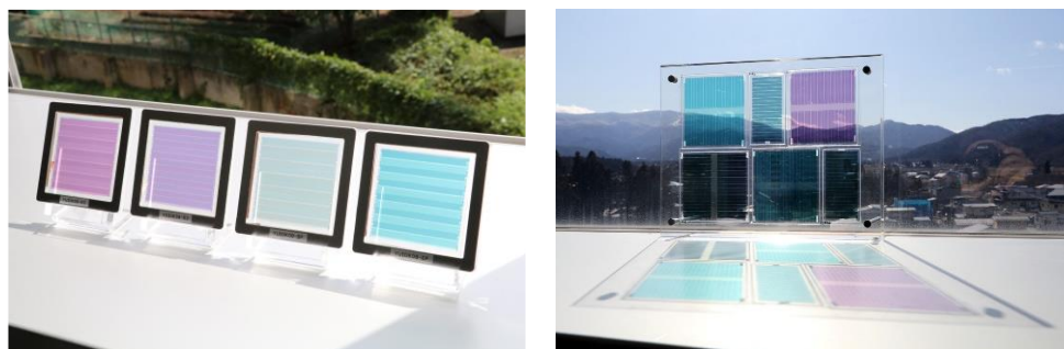
試作した多色・透明有機薄膜太陽電池パネル
