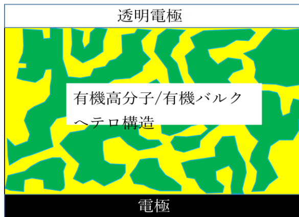
Figure 1 有機太陽電池にみられるバルクヘテロ構造
