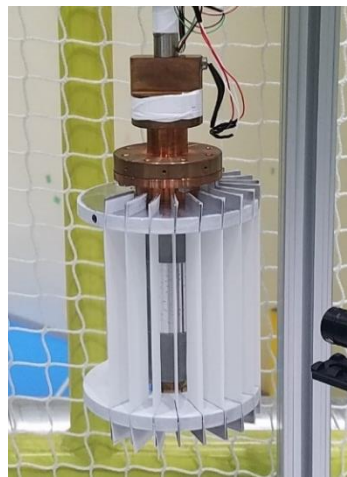
図 5：試料スティックに取り付けたメゾアライト製圧力セルとラジアルコリメーター試作機。
