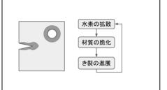
図1:き裂や穴からの水素拡散と、 脆化によるき裂進展(概念図)。
