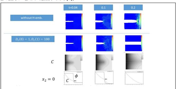
図2:水素脆化の効果を含まない場合と、含む場合における開口モードき裂進展の時間発展。 上から、水素脆化の効果を含まない場合の変形とき裂進展の様子、水素脆化効果を含む場合 の変形とき裂進展の様子、正規化された水素濃度 Cの分布、初期き裂を含む断面での水素濃度 C とフェーズフィールドØの分布。
