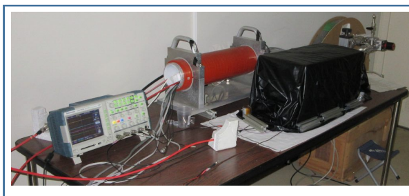
図 5 試験の様子。撮像管は黒布で遮光された暗箱にある。
