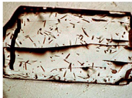
図1: アパタイト粒子中の自発核分裂飛跡(フィッション・トラック)。酸やアルカリでエッチングを施すことによって、光学顕微鏡での観察・計数が可能になる。
