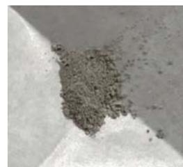
図4 Pd(PPh<sub>3</sub>)<sub>4</sub>含有カプセル
