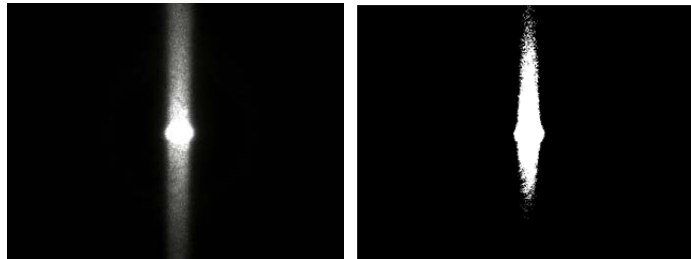
図2 レーザ反射光分布画像の原画像(左)と2値化処理(右)
