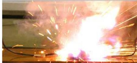
図 4 半断線部に置いた可燃物への着火
