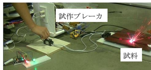
図 7 試作ブレーカ性能評価の様子
