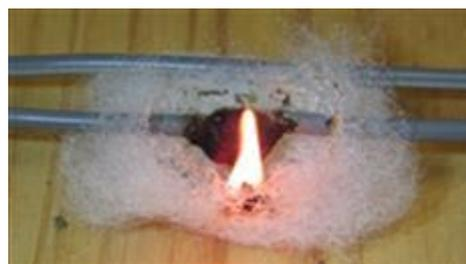
図10 素線断線時の可燃物への着火
