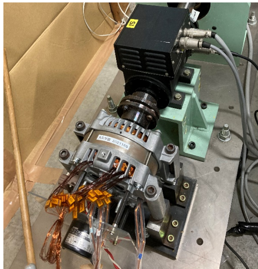
図8 各部磁束モニタリングを可能とするデュアル巻線用モータの試作機外観写真
