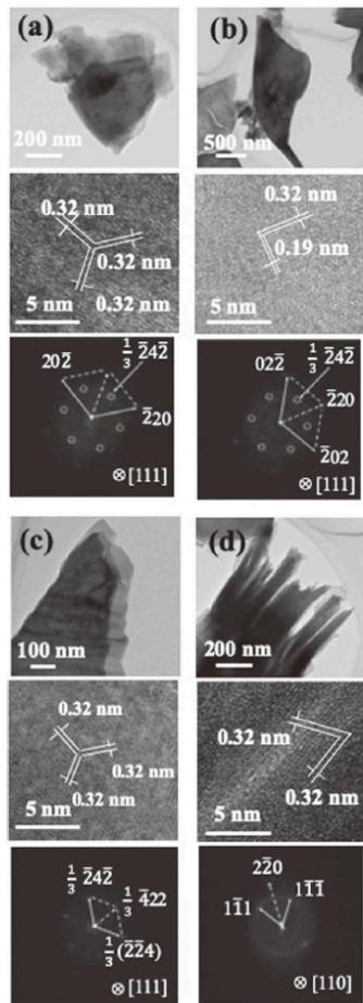
図6. CaGe<sub>2</sub> の IP6 处理により作製した(a)水溶液表面に浮遊、(b)水溶液中に浮遊、及び(c)容器底に堆積したGeナノシート剥離片をシート面に垂直な方向から観察したTEM, HRTEM像及びFFTパターン、(d)水溶液中に浮遊した剥離片を断面方向に観察したTEM, HRTEM像及びFFTパターン<sup>5)</sup>.
