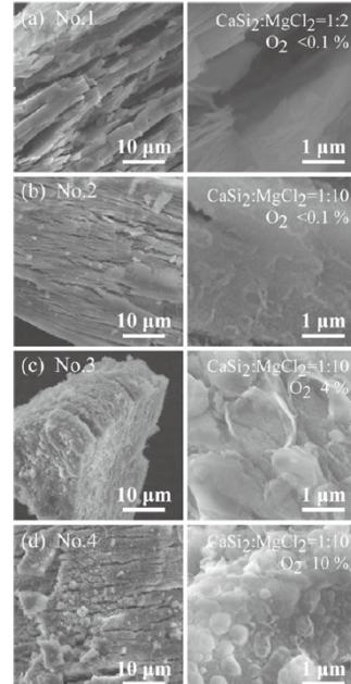
図7. CaSi<sub>2</sub> の酸素(水分)を含むMgCl<sub>2</sub>雰囲気下における熱処理により作製したMg<sub>2</sub>SiO<sub>4</sub>ナノシート束のSEM像<sup>6)</sup>.
