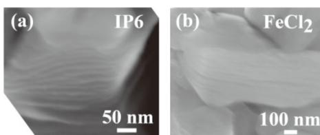
図1. Si基板上に成長させた $\text{CaSi}_2$ よりIP6及び $\text{FeCl}_2$ を用いて作製したSiナノシート束のSEM像<sup>1)</sup>.
