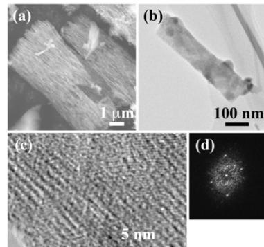
図 9.  $\text{CaCuSi}_4\text{O}_{10}$  を HF 及び IP6 処理により作製した酸化物ナノシート束の SEM, TEM, HRTEM 像及び FFT パターン<sup>8)</sup>.
