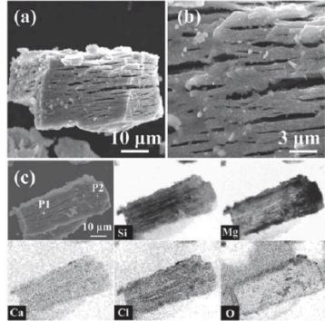
図4.  $\text{CaSi}_2$  の  $\text{MgCl}_2$  による熱処理により作製した  $\text{Mg}_2\text{Si}/\text{Si}$  ナノシート束 コンポジットの SEM, STEM 像及び EDS マッピング<sup>3)</sup>.
