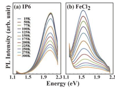
図2. Si基板上に作製したSiナノシート束のフォトルミネッセンススペクトル<sup>1)</sup>.
