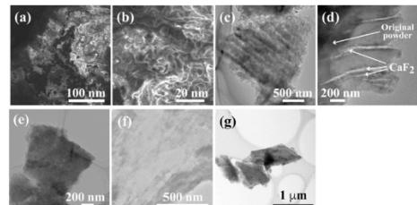
図8. CaSi<sub>2</sub> の HF 处理により作製したCaF<sub>2</sub>ナノシート束のSEM及びTEM像<sup>7)</sup>.
