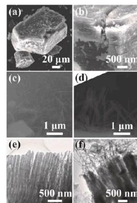
図5.  $\text{CaSi}_2$  の  $\text{MnCl}_2/\text{NH}_4\text{Cl}$  による熱処理により作製した Si 系ナノシート/ナノワイヤ複合体の SEM 及び TEM 像<sup>4)</sup>.
