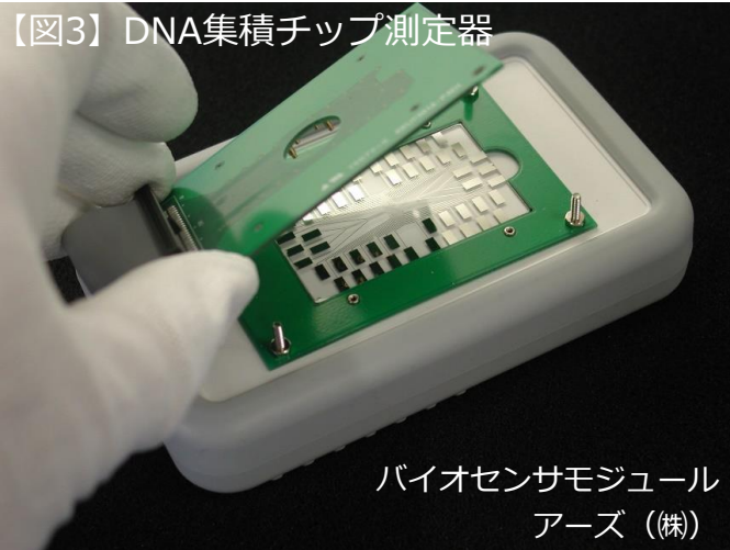
図3 電極基板専用に設計、開発した評価測定器
