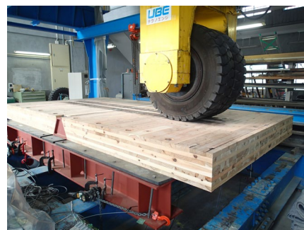
写真2 CLT床版の輪荷重走行試験
