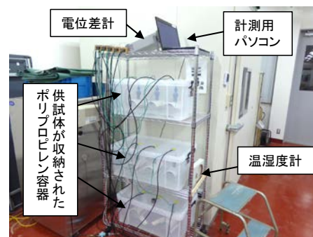
図-3 鉄筋の腐食開始特定実験
