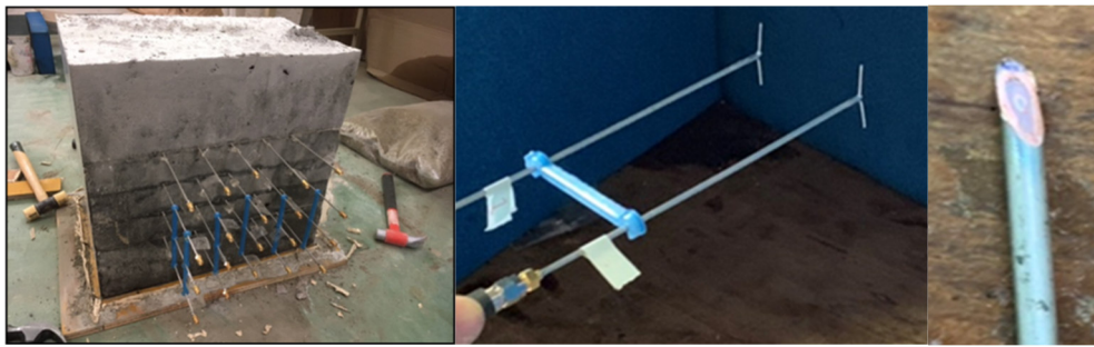
(a) コンクリート試験体 ダイポールアンテナとスペーサー プローブ
