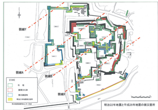
図-1 被災石垣と推定弱層の位置
