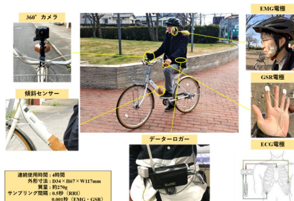
図1 実験装置の概要：計測機器及び電極取り付け位置
