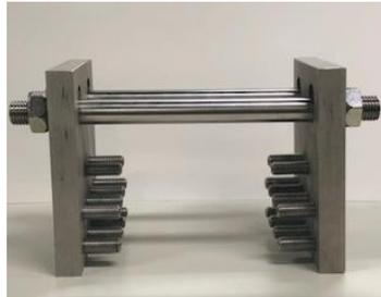
写真1 改良型簡易載荷治具
