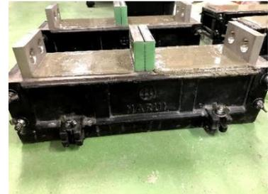
写真2 供試体打ち込み状況
