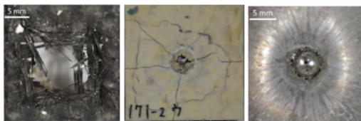
Fig. 4(2)-4 PAN 試料の衝突面(左)、背面(中)、およびアルミニウム板の凹み(右)
