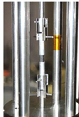
図5 REBaCuO バルクの引張試験の様子
