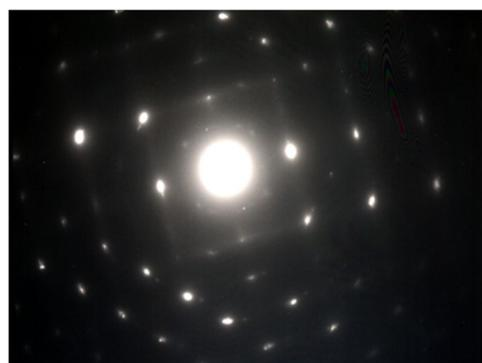
図10  $Mg_2Si$ 微粒子の電子線回折像
