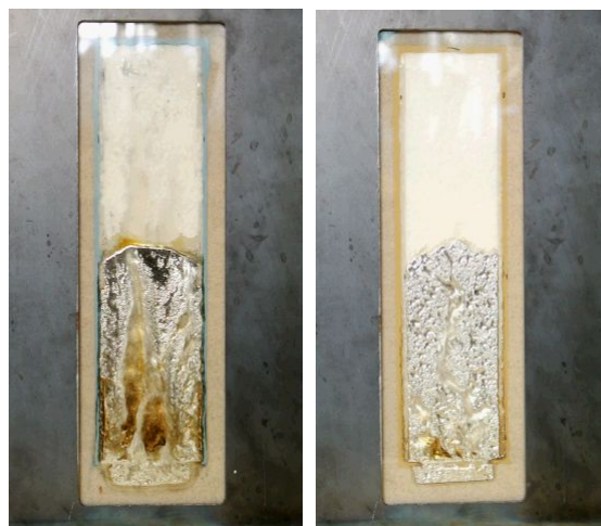
(a) P=0.18 (b) P=1.7 図 1 押上げ方案の場合の湯流れ直接観察結果
