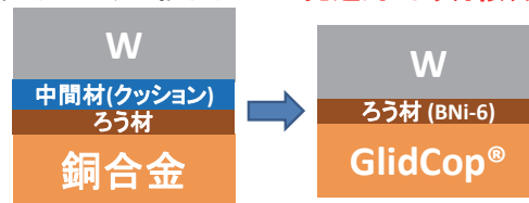
図1. 従来のろう付接合法と先進的ろう付接合法の比較模式図。
