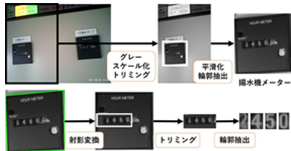
図 1 揚水機メータの画像処理の流れ
