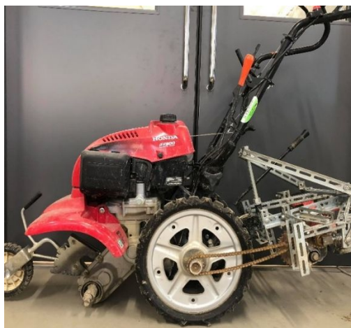
図 2 2020 年に供試した歩行除草機の側面
