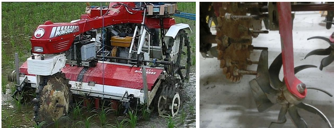
図1 2018年に供試した乗用除草機的全景(左)と、条間ロータ背後の株間除草機構(右)
