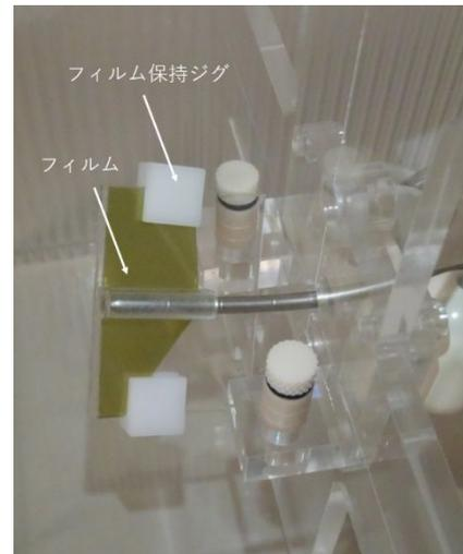
完成したオールインファントムを用いて、自施設での検証測定から開始した。その結果、概ね想定通りの測定ができることがわかったが、蛍光ガラス線量計の出力応答について、4か所に設置した蛍光ガラス線量計出力値と治療計画装置による計算値の比較で、最大で10%を超える相違が観測された。このため、蛍光ガラス線量計の線質依存性をより直接的に補正するために、蛍光ガラス線量計の設置位置に微小な領域での線量評価が可能なマイクロ電離箱である Pinpoint 電離箱を挿入できるようなジグを作成し、それを併用して線質を補正する方式を採用した。この結果、4か所での出力値は治療計画装置の出力値に近づき、4か所の線量評価点での相違はほぼ10%以内に収まった。Pinpoint 電離箱を挿入できるように改良したファントムは下図の通り。
