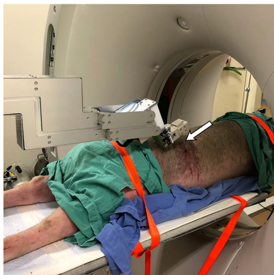
図2 動物試験における3次元穿刺 矢印：穿刺針
