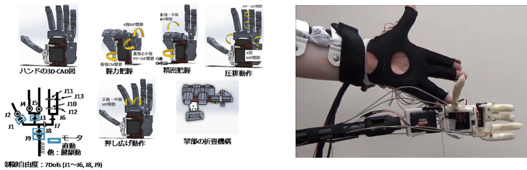
図3：手掌部の折畳機構を有する5指ロボットハンド
