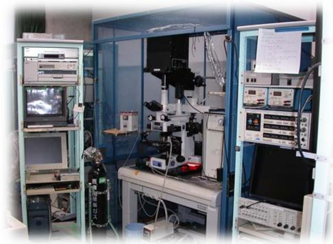
図 2：大型の光学顕微鏡 (Nikon Eclipse E800) の上に載せてある黒い大きな箱の中に、464 本の光ファイバーと 464 個のフォトダイオード・I-V コンバーターが納められている。
