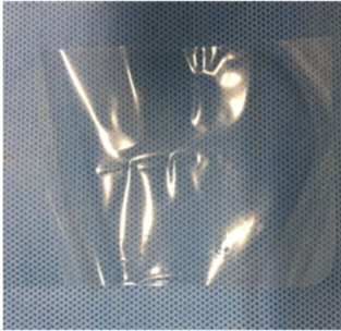
図2: リン酸化プルランフィルム。リン酸化プルランをフィルム状に形成することで、用途に応じて自由に形成可能である。
