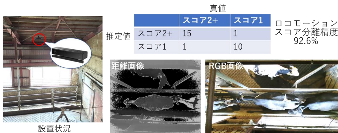
図 2 酪農学園大学 (北海道) におけるカメラの設置と蹄病推定精度
