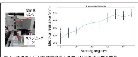
図4 間接角センサ評価装知置と角度に対する抵抗値の変化
