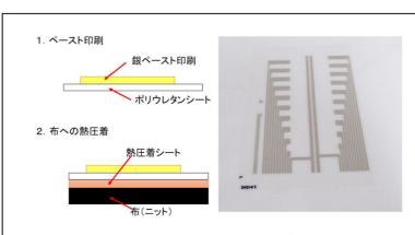
図 5 配線構造と伸縮性銀ペーストとポリウレタンフィルムによる 配線
