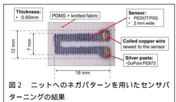
酸 ( PEDOT: PSS)を用い た。 PEDOT の布へのパ ターニング は、ネガパ ターンとし てポリジメ チルシロキ サン(PD MS) を利 用した。ネ ガパターン として PDMS ( KE-1308 信越化学) を先に印刷
