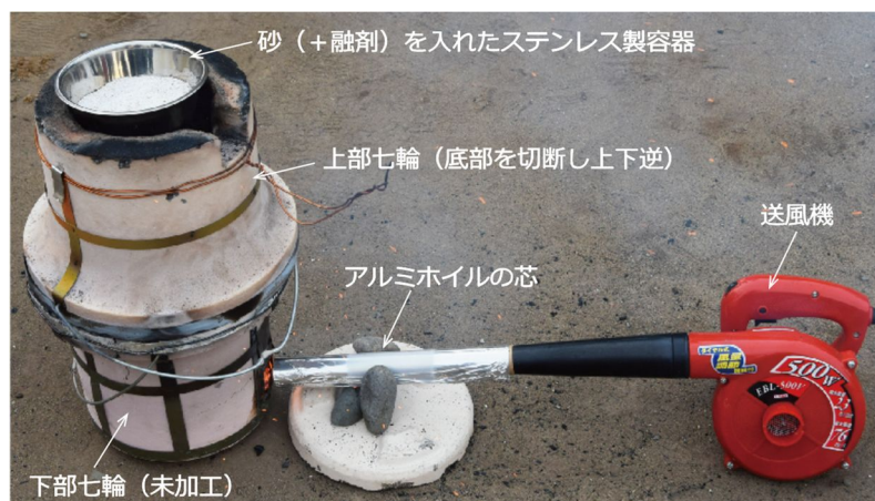
図 1. 七輪マグマ実験装置(ドライヤーの代わりに送風機を使用)。
