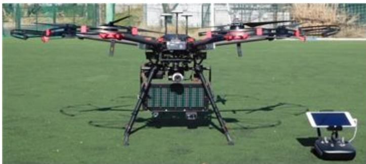
図-1 音源搭載型 UAV の外観写真
