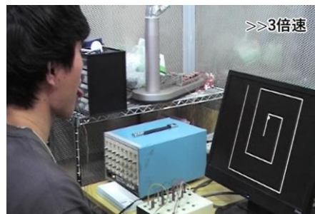
図6：舌の動きに応じて画面上のマウスカーソルを動作させるシステム[2]
