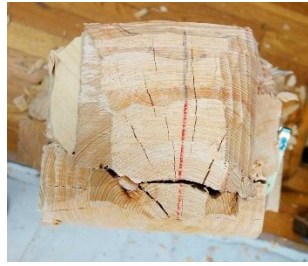
図 13 粗取り後の模刻像上面画像(再内割り前)
