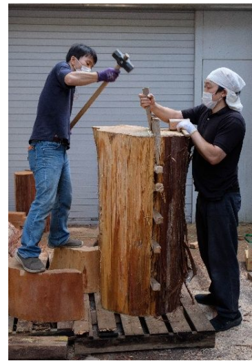
図8 ヒノキ材の打割製材
