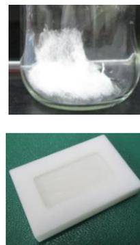
図 3. 精製 Ag32 ポリペプチド (上) とキャストフィルムの作製 (下)
