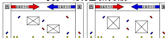
● 鉛直測定用応力計 ● 正荷重時測定用応力計 ● 負荷重時測定用応力計
