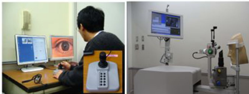
a) 眼科医操作ユニット(枠内は操作スティック)
