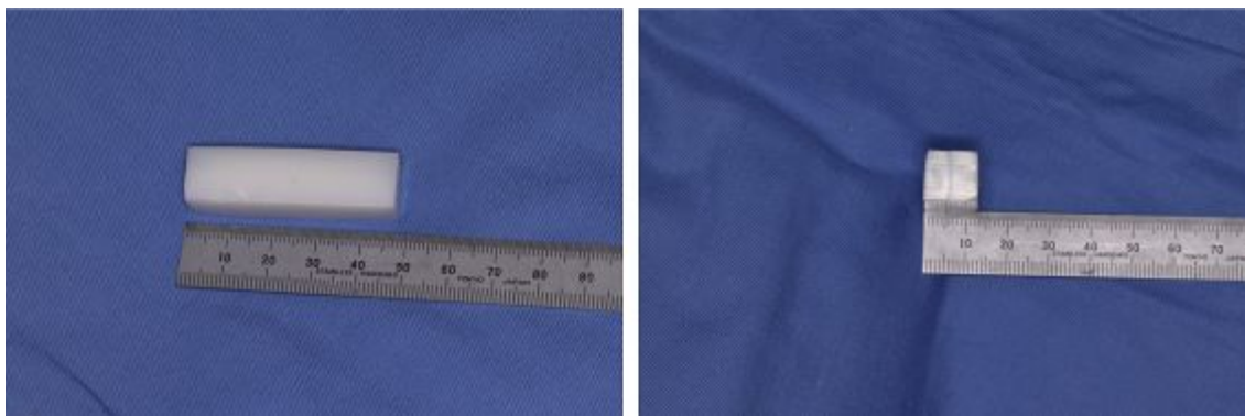
図 6: 試作した積層型高透光型ジルコニア試料の一例。
