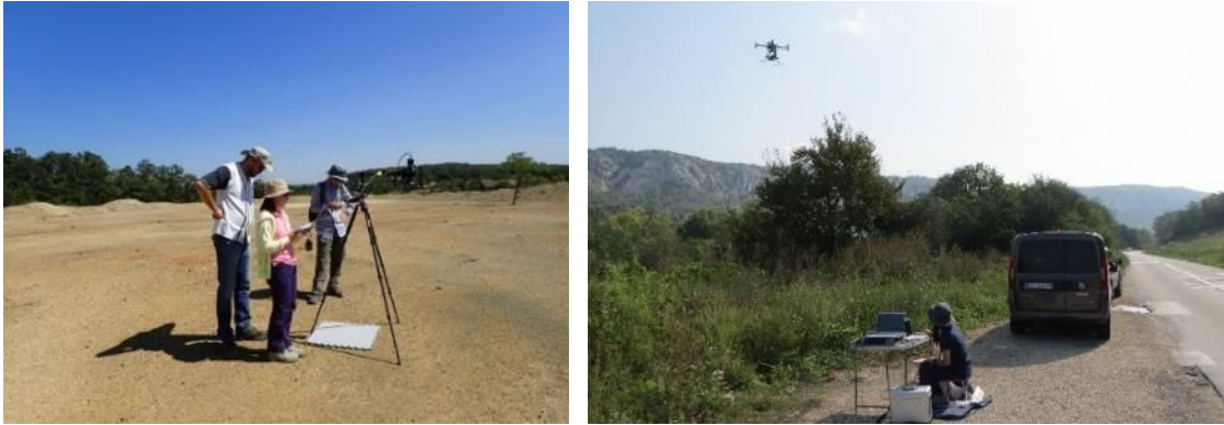
図 2. 空撮によらない LCTF カメラによる試験撮影と LCTF-UAV 空撮の様子 (Wi-Fi を利用し遠隔でカメラを操作している)
