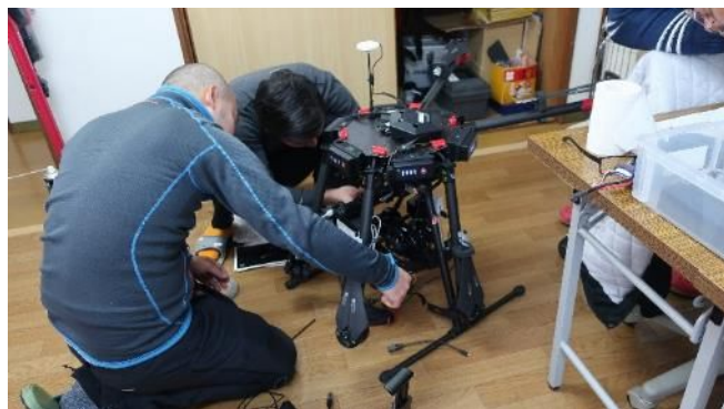
図 4. UAV 専門技術者による LCTF カメラの搭載調整
