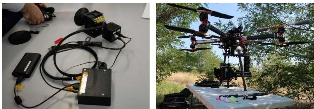
図 1. 本研究で使用した LCTF カメラ (左) と LCTF を UAV に搭載した状態 (右)
