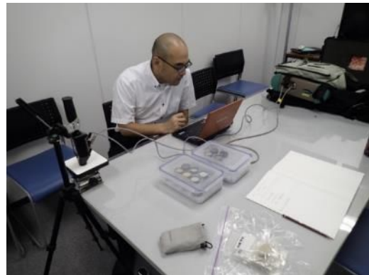
図 3. 実験室における分光器による反射特性測定
