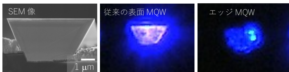
図 4 結晶構造の断面 SEM 像および強励起端面 PL 時の近視野像
