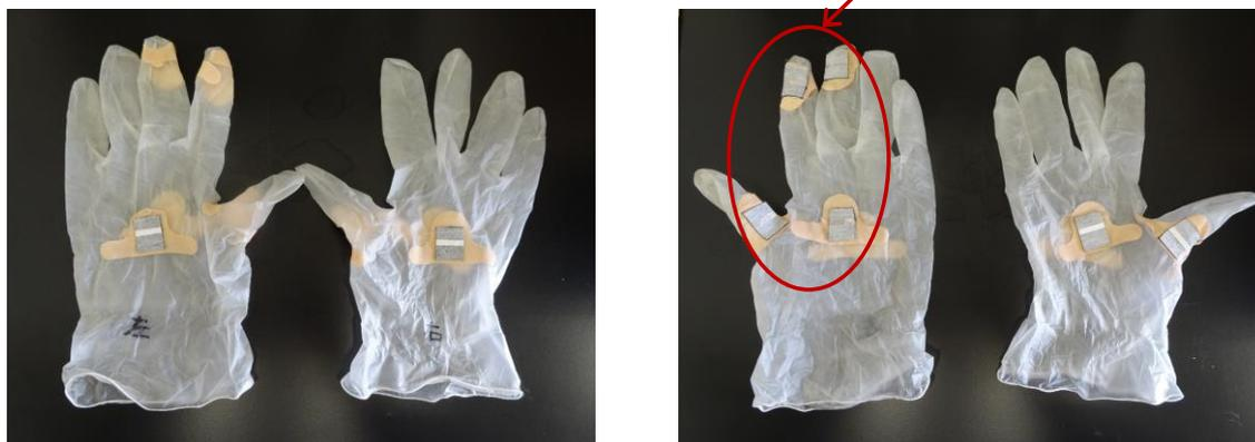
図 2 保護着破過インジケータの写真 (軍手着用時のインナー手袋)
