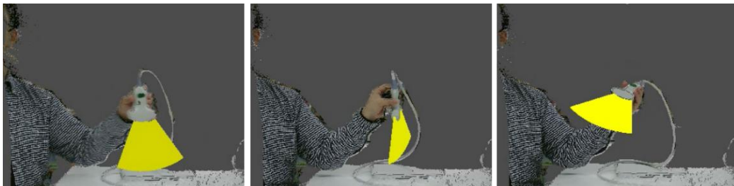
図 5 プローブの位置・姿勢推定結果
