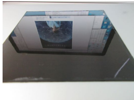
図 4 シリカコーティングした CFRP による反射像
