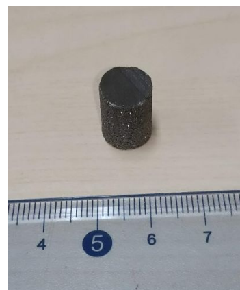
図1:電子ビーム積層造形法によって製造に成功したタングステン材
